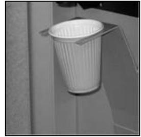
4. Essuyez l'intérieur de la porte, le support de gobelet et la zone de distribution à l'aide d'un chiffon propre, désinfecté et humide.
