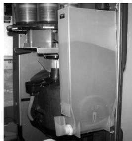
Placez le bac dans le poste de remplissage du bac situé sur la porte et remplissez le bac avec l'ingrédient correct.
