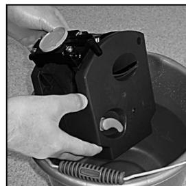
3. Retirez l'assemblage de conduit à café en grains. Dévissez les deux vis à tête moletée, puis retirez le conduit à café et son couvercle.
