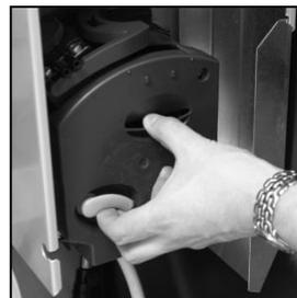
2. Placez doucement l'unité de l'infuseur CoEx® dans la solution bactéricide diluée et nettoyez-la soigneusement. Assurez-vous d'avoir retiré tous les dépôts de café moulu, en faisant particulièrement attention à la partie qui entoure le haut du piston et le conduit de récupération.
