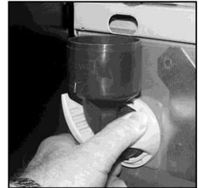
10. Bringen Sie die Kondensatabscheider wieder an die Mischsysteme an und achten Sie darauf, dass der Auslass auf das Abzugsgehäuse ausgerichtet ist.
