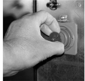
9. Richten Sie das Mischsystem auf die Bodeneinheit aus und achten Sie darauf, dass der grüne Hebel nach links gedreht ist. Drücken Sie das Mischsystem bis zum Anschlag in die Bodeneinheit und drücken und drehen Sie den grünen Sperrmechanismus nach rechts, um sie festzustellen.
