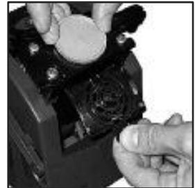
2. Drücken und geben Sie die Taste [11] auf der Wartungstastatur frei und befolgen Sie die Anweisungen auf der Hauptanzeige, d.h. drücken Sie **Reinigung starten**. Nach Spülen und Durchlaufen des Brüherzyklus erscheint folgende Meldung auf dem Bildschirm **Reinigungstablette bitte in den Brüher geben**.
