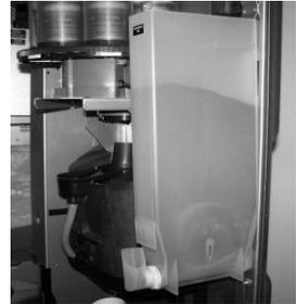
Setzen Sie den Behälter in die Behälterfüllstation in der Tür und füllen Sie den Behälter mit dem richtigen Produkt.
