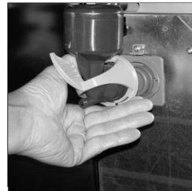
5. Bauen Sie die Abzugsschale vom Automaten aus. Reinigen Sie den Bereich unter der Abzugsschale mit einer trockenen Bürste.
