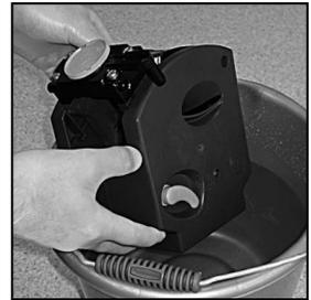
3. Entfernen Sie die Kaffeerutsche des B2C-Automaten. Lösen Sie die beiden Rändelschrauben und entfernen Sie die Kaffeerutsche und die Kaffeerutschenabdeckung.
