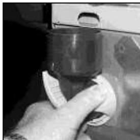
9. Bringen Sie die Kondensatabschneider wieder an die Mischesysteme an und achten Sie darauf, dass der Auslass auf das Abzugsgehäuse ausgerichtet ist.
