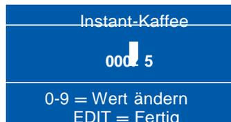
4. Drücken Sie die Taste  $\blacktriangleleft$  (Eingabe), um zum Menü "Individuelle Preise" zurückzukehren, und vergewissern Sie sich, dass der neue Preis in der Statusleiste am unteren Rand des Displays angezeigt wird. Benutzen Sie die Tasten  $\blacktriangle$  (Auf) oder  $\blacktriangledown$  (Ab), um weitere Optionen zu markieren.
